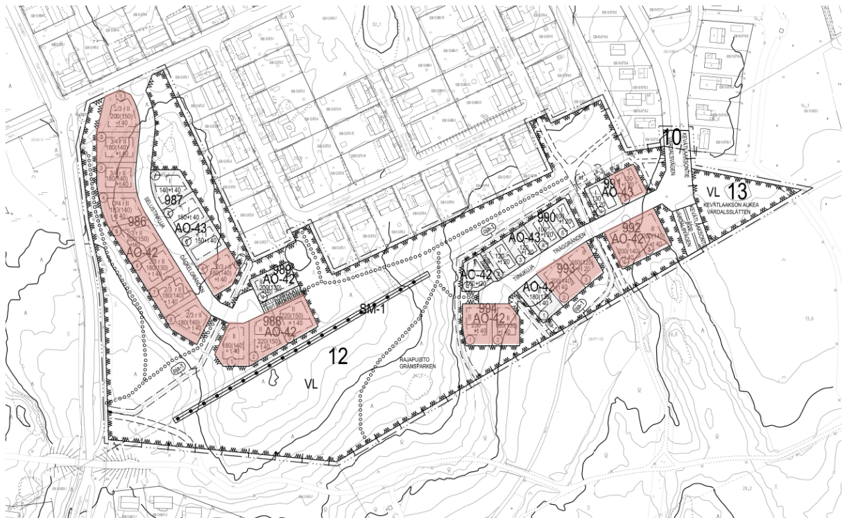
Bild 14. Tomter som ska förbereda sig att pumpa avloppsvattnet till avloppsledningen vid gatan.
