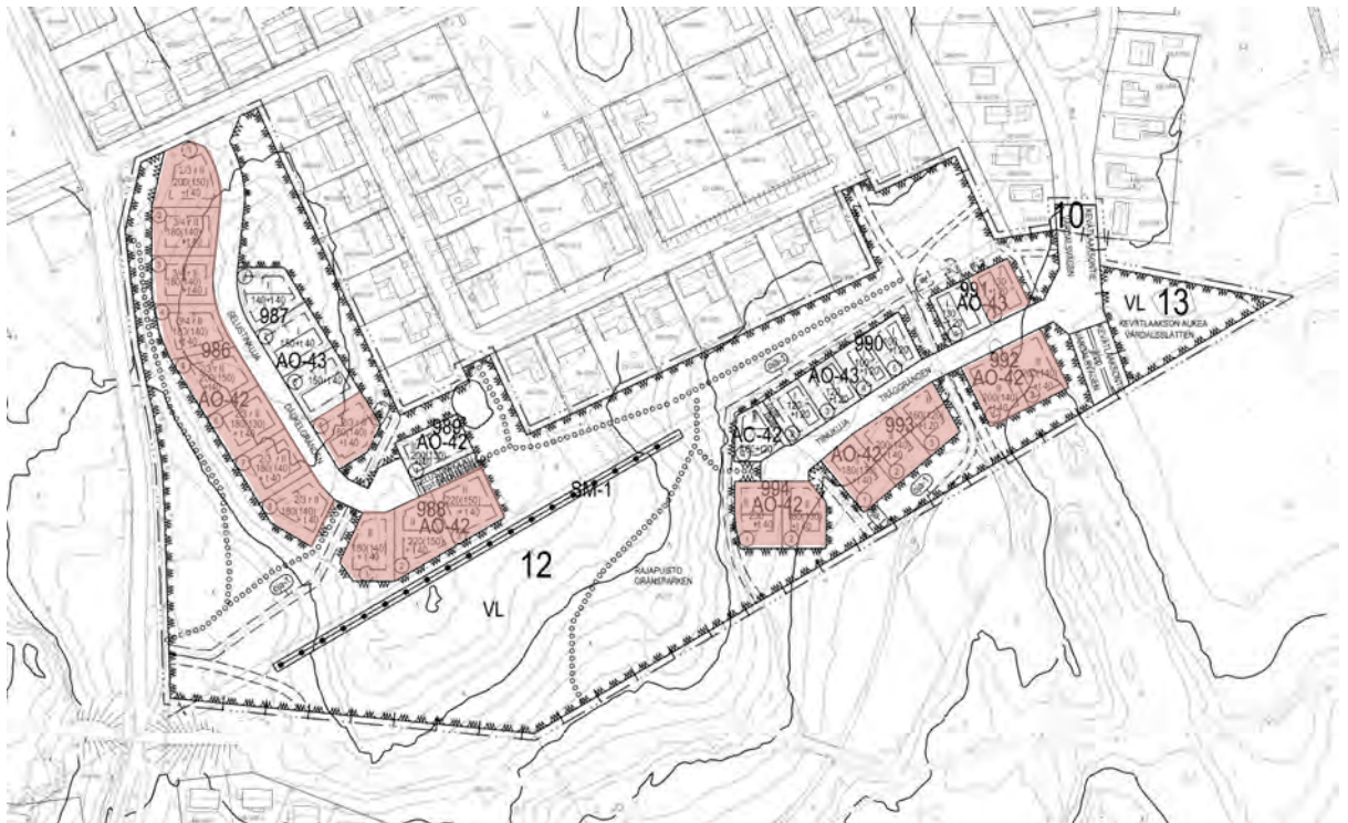
Kuva 14. Tontit, joilla tulee olla valmius pumpata jätevesi kadun viemäriputkeen.
