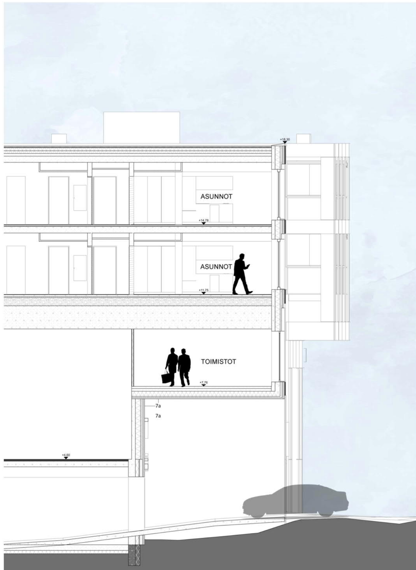
Julkisivuleikkaus itään, pysäköintihallin sisäänajo 1:100
