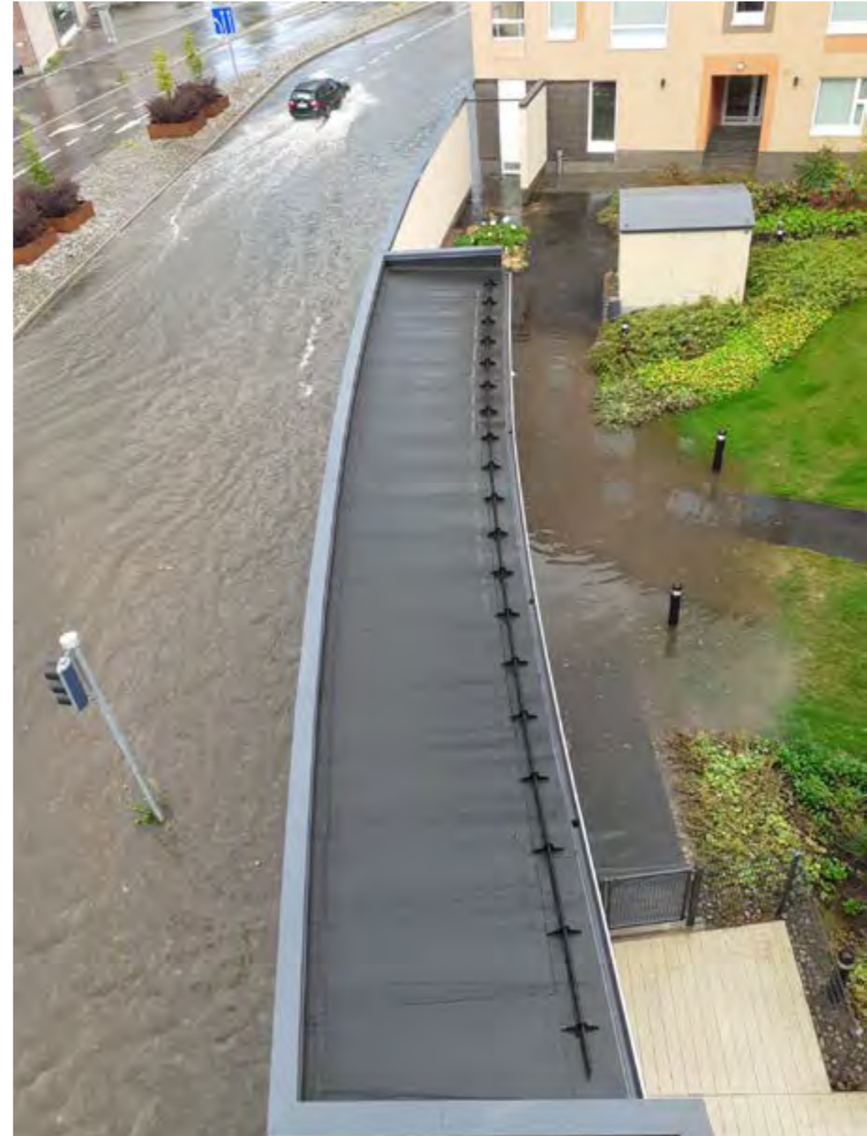
Kuva. Lämpäsemättömät pinnat, kuten asfaltti, eivät imeytä hulevesiä.
